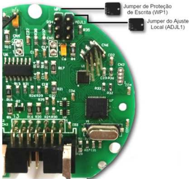
Figura 3.2 – Detalhe da placa principal com jumpers.
